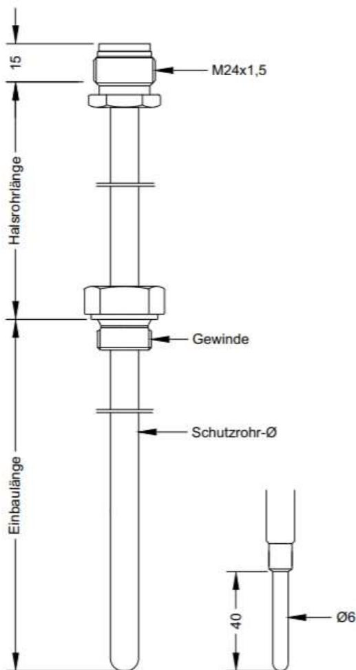
Einbaulänge+ Halsrohrlänge + 25 mm
