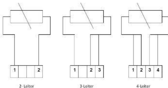
Das Anschließen der freien Drahtenden erfolgt bei Kabelfühlern analog mit Anschlusskopf! Bei Mehrleiterschaltung gehören jeweils die Drahtenden mit dunkler bzw. heller Isolierung paarweise zusammen.
